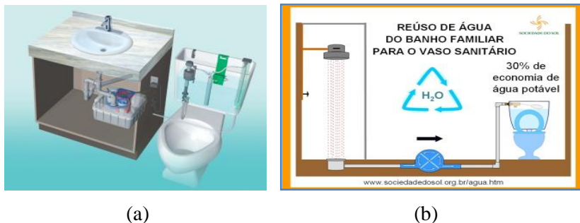
Figura 21 - (a) Reúso de água da pia para o vaso sanitário e (b) Reúso de água do banho familiar para o vaso sanitário.
