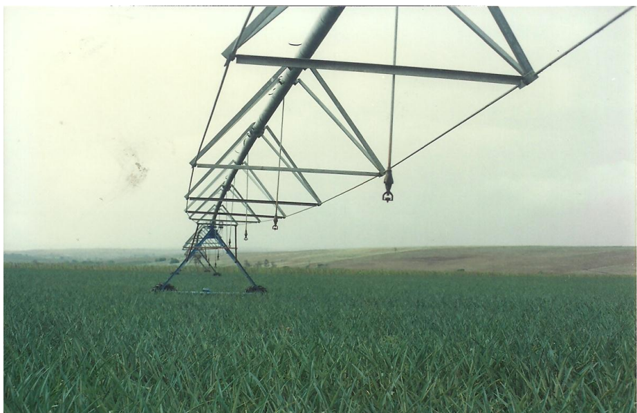
Figura 2.13 – Vista longitudinal com torre do pivô sobre roda pneumática
