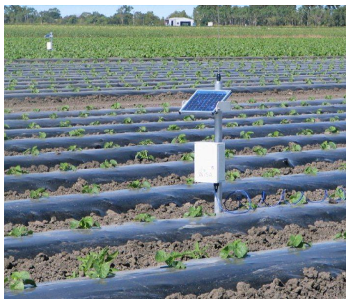
Figura 9.3 - Exemplos de unidades remotas operando com energia solar
