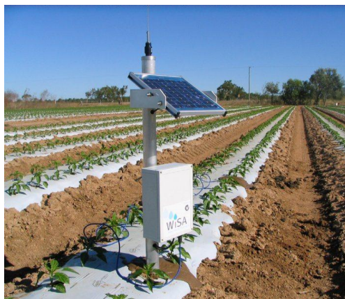
Figura 9.3 - Exemplos de unidades remotas operando com energia solar
