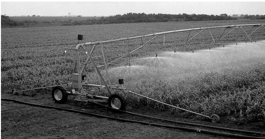
Figura 2.15 - Captação através de mangueira
