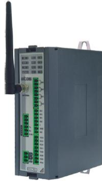
Figura 9.4 - CLP com modem GSM integrado (Fonte: www.atos.com.br )
