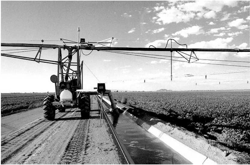
Figura 2.14 - Captação direta de um sistema lateral móvel
