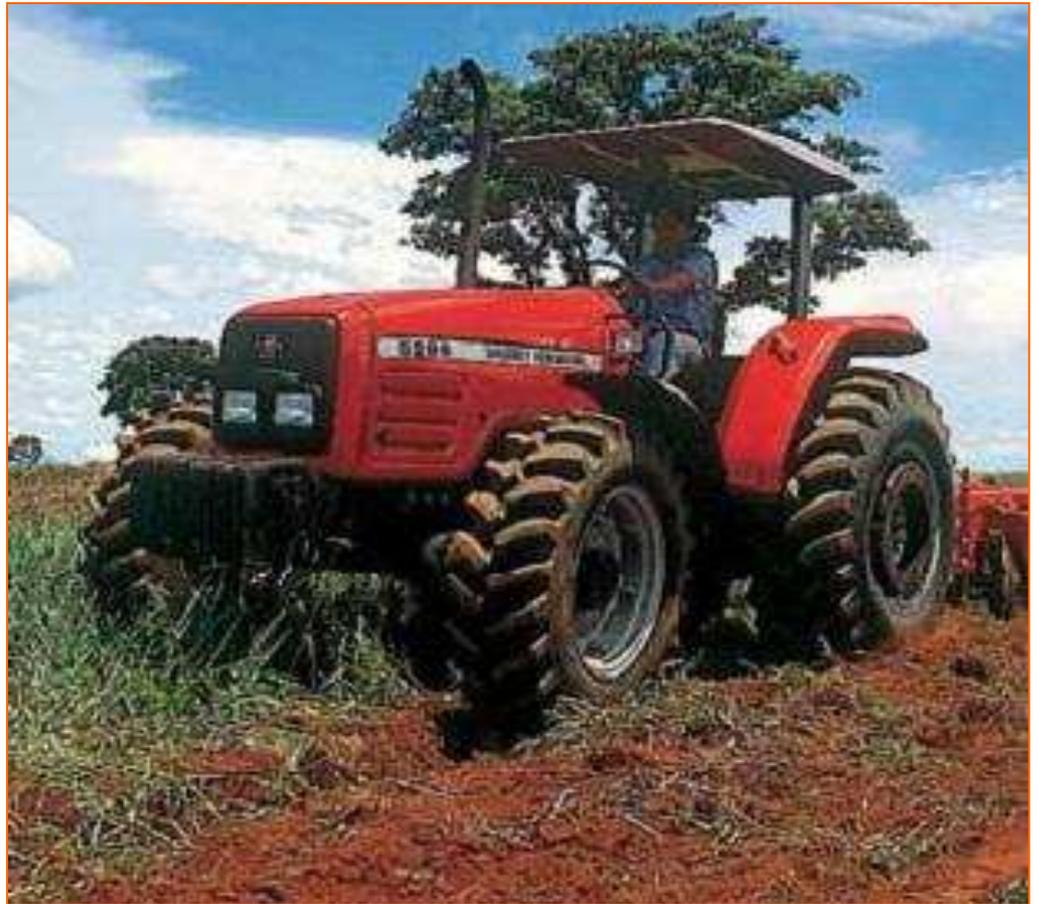
Figura 4 Trator de quatro rodas com tração dianteira auxiliar
