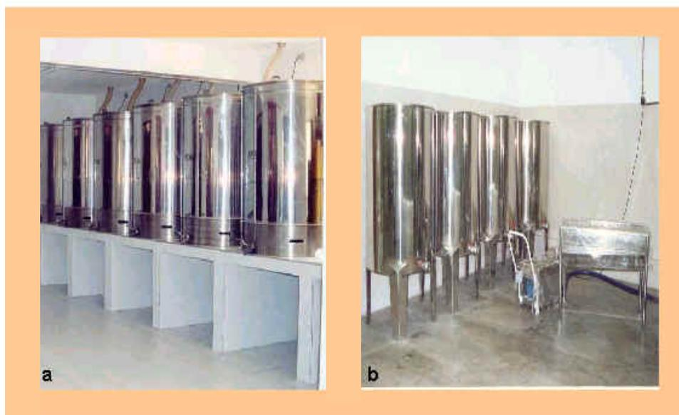
Figura 46. Modelos de decantador (a e b), mesa coletora de mel e bomba de mel (b).
