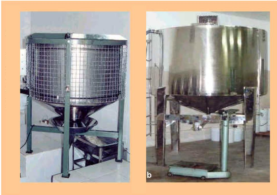
Figura 47. Equipamentos utilizados na extração e processamento do mel: centrífuga (a) e tanque homogeneizador (b).
