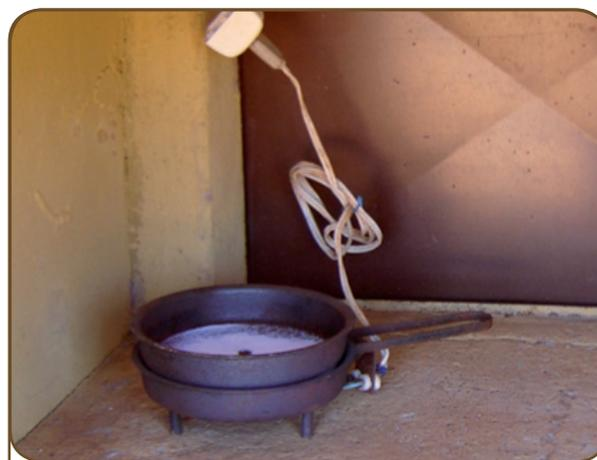
Figura 22: Fumigador para desinfecção de materiais.
